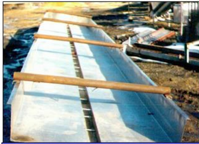
2.- S/S FINISHING VAT LINER
