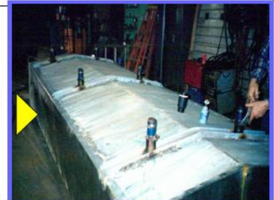
3.- Rebuilding the Vat Exterior Bottom & Sides
